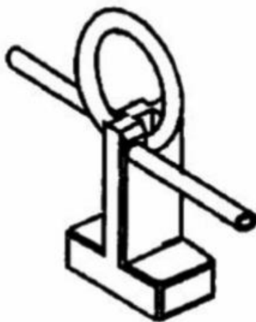
图 E.1 耐弯曲性试验工具及亲水涂层乳胶导尿管安装图
